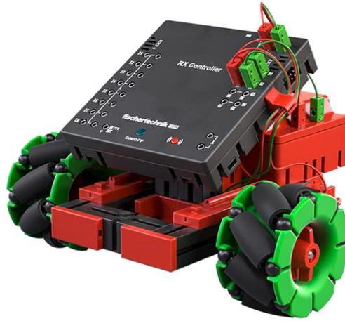
Wenn du das Modell anhand der Bauanleitung aufgebaut hast, sind dir sicher schon zwei neue Bauteile aufgefallen – die Omniwheelräder und das Stützrad.
