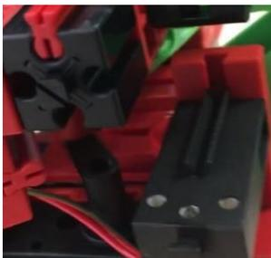
Über den Kurbellauf, dem Getriebe des Abschussmotors, wird die grüne I-Strebe nach hinten gebogen. Der Motor dreht nach links bis zum Taster weiter und gibt, die auf Spannung gebogene I-Strebe, frei. Diese katapultiert mit Ihrer Spannungsenergie den kleinen Ball nach vorne aus der Abschussvorrichtung.
