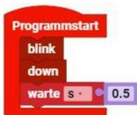
Nachdem alle Funktionen definiert sind, kannst du das Hauptprogramm beginnen. Beginne zuerst mit den Funktionen zur Aufnahme der Palette. Das Modell steht mit der Gabel vor der Palette. Wird das Programm gestartet, blinkt die LED. Anschließend fährt die Gabel in die Endposition und wartet dort „0,5“ Sekunden.
