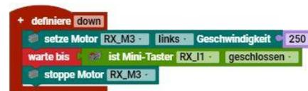
Beginne mit der Funktion „down“. Mit ihr wird die Gabel abgesenkt bis der Endtaster betätigt wird Motor RX\_M3“. Da du schon Funktionen erstellt hast, findest du die Lösung auf der rechten Seite.
