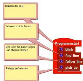
Nach dem Programmstart soll zuerst die LED blinken. Anschließend soll das Modell die schwarze Linie finden bzw. der Linie folgen. Am Endpunkt A der Linie bleibt das Modell über den Stop-Befehl in der Funktion „follow\_line“ stehen. Mit der Funktion „pick\_up“ wird die Palette aufgenommen.
