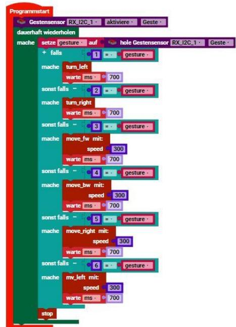
Zum Schluss musst du noch die Leerräume von „mache“ definieren. Dazu kannst du schon einmal den „warte“-Befehl duplizieren und an die einzelnen Stellen einfügen. Für den Wert „2“ fügst du „turn\_right“ ein, für „3“ „move\_fw“, für „4“ „move\_bw“, für „5“ „move\_right“ und für „6“ „move\_left“ ein. Die „speed“-Parameter müssen mit „300“ festgelegt werden. Am Ende der Schleife fügst du noch die Funktion „stop“ ein.
