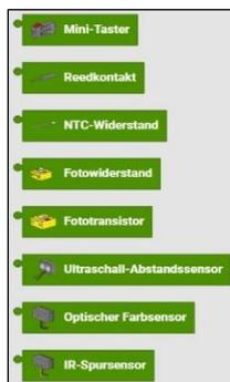
Den Taster findest du unter „Eingang“. Aktiviere die Auswahl mit der Maus und es werden alle zur Verfügung stehenden Sensoren angezeigt. Ziehe hier „Mini-Taster“ in den Arbeitsbildschirm und docke diesen an die freie Anschlussstelle an.
