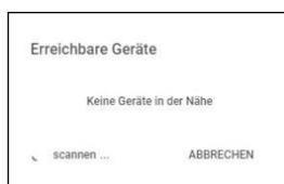
Es öffnet ein weiteres Kontextfenster. Hier wird nach einem Gerät in der Nähe gesucht „scannen“. Drücke die „Bluetooth-Taste“ bis das rechte Kontextfenster erscheint. Hier wird das erreichbare Gerät angezeigt, z.B.: RXC639b. Die blaue LED am Controller blinkt langsam.
