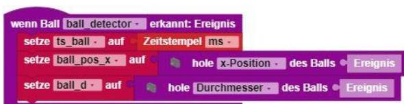
Die Werte werden ins Hauptprogramm übergeben und der Roboter fährt auf den Ball zu, bis die Lichtschranke, die am vorderen Teil des Roboters befestigt ist, unterbrochen wird.
