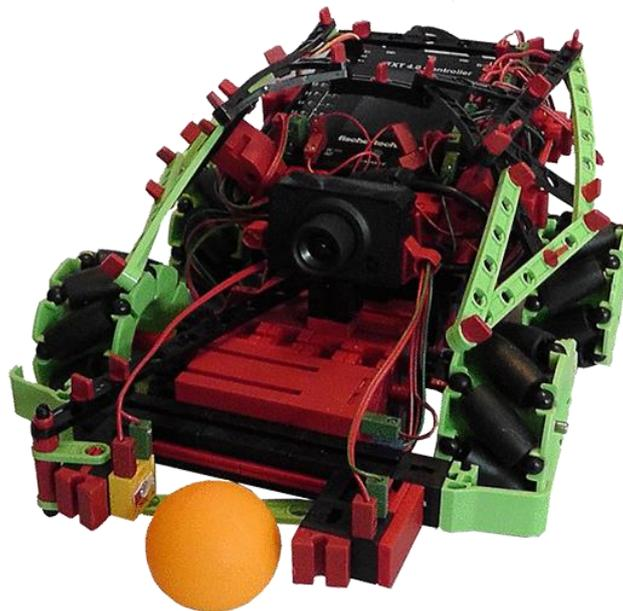
Mit diesem Modell werden nochmals die Aktoren wie Encodermotor, Servo und als Sensoren die USB-Kamera und der Fototransistor verwendet
