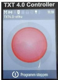
Erkennt die Kamera eine Bewegung, schaltet die Anzeige auf den Status „wahr“ um und ein Ton wird über den Lautsprecher am TXT 4.0 Controller ausgegeben.
