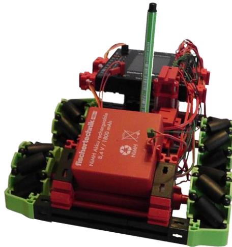
Mit dem Malroboter kannst du verschiedene Figuren auf ein Blatt Papier zeichnen. Verschiedene Geometrien kannst du über das Display des TXT 4.0 Controllers auswählen. Über den Servo wird der Stift angehoben und abgesenkt. Justiere den Stift so, dass er in der unteren Position den Boden berührt und in der oberen Position Abstand vom Boden hat.
