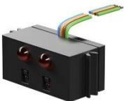
Der Infrarot-Spursensor ist ein digitaler Sensor zur Erkennung einer schwarzen Spur auf weißem Untergrund mit einem Abstand von 5 – 30 mm. Er besteht aus zwei Sende- und Empfängerelementen.
