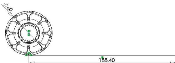
Die Darstellung zeigt die Strecke in mm wenn das Rad eine Umdrehung macht. Wie ermittelt man aber die Strecke? Dazu dient dir die mathematische Formel zur Berechnung der Länge des Umkreises des Rades.
