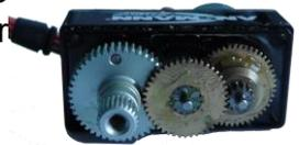
Die Servos werden über die Pulsweitenmodulation „PWM“ gesteuert.
