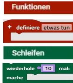
Ziehe aus „Funktionen“ den Befehl „definiere etwas tun“ in den Programmbildschirm. Ersetze „etwas tun“ mit „move\_sideways“. Diesem folgt der Befehl „wiederhole x mal“ aus dem Bereich „Schleife“. Ändere hier die Wiederholrate auf „3“ um.
