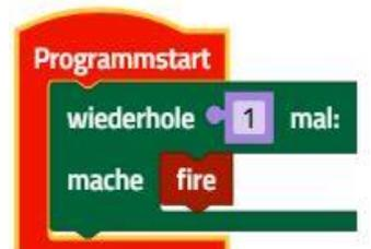
Das Hauptprogramm ist sehr einfach und besteht nur aus dem Programmstart und einem Schleifenbefehl. In diesem wird der Funktionsblock „fire“ eingebaut. Die Schleife soll zuerst einmal durchlaufen werden.
