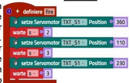
Dadurch wird der Ball nach vorne aus dem Katapult geschossen. Die Servoposition „230“ dient als Sperre für die Bälle, die sich noch im Magazin befinden.
