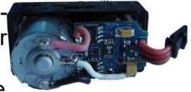
Das Anschlusskabel besteht aus drei Leitungen. Diese sind die Spannungsversorgung Vcc (rot), der Masse GND (braun) und der Signalleitung PWM (gelb).
