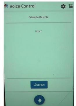
Die Spracheingabe wird an den Controller gesendet und dort von dem ROBO Pro Coding Programm weiterverarbeitet.
